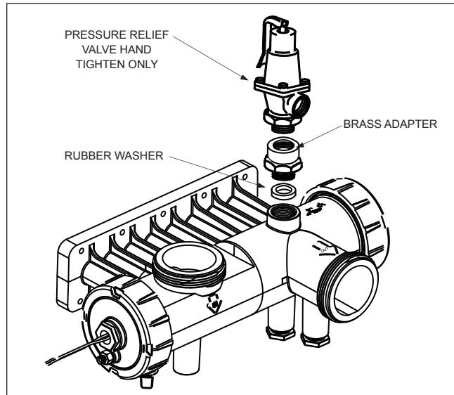
**Figure 19. Pressure Relief Valve Installation**
